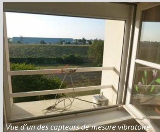
Vue d'un des capteurs de mesure vibratoire
