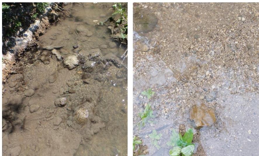
Figure 4 : différence de granulométrie en fond de lit entre 2015 (à gauche) avec une grande partie de fines, et 2022 (à droite) avec une proportion importante de cailloux fins
