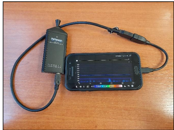
Figure 6 : Micro M500-U384 relié à un téléphone portable équipé de l'application BatRecorder
