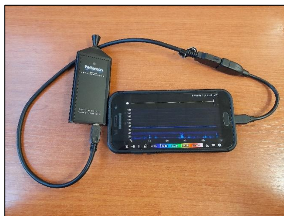
Figure 5 : Micro M500-U384 relié à un téléphone portable équipé de l'application BatRecorder
